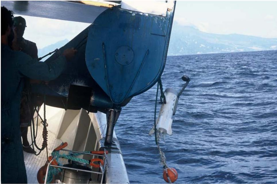
**Figure 42. Caméra vidéo sous-marine dans son caisson étanche prête à être immergée via le vire filet (photo ©Ifremer M. Doray).**
