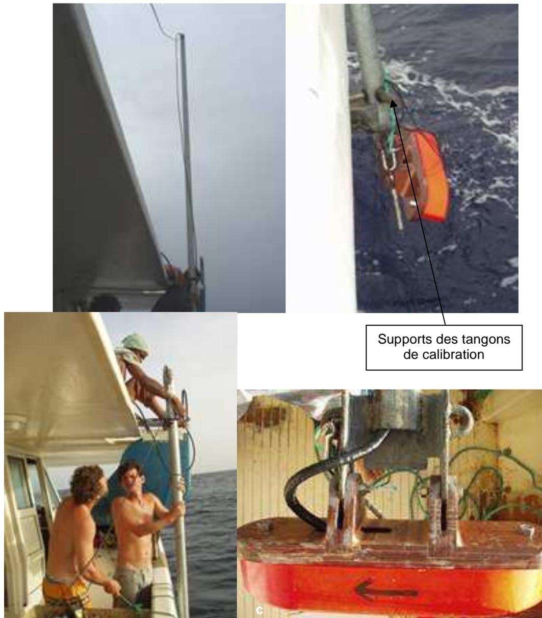
**Figure 26. a. Perche télescopique en position haute ; b. Sabot et transducteur ellipsoïdal le long de la lisse du navire en position haute ; c. Perche en position basse ; d. Détail du sabot et du transducteur.**
